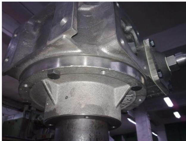
Seguidamente colocaremos el cuerpo nº1 en posición horizontal y procederemos a montar la otra parte de la bomba.
