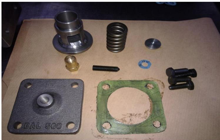
Para montar el bypass comenzaremos introduciendo la válvula nº 14 en el hueco del cuerpo nº1 de la bomba que está encima de la boca de aspiración. (Para un montaje estándar)
